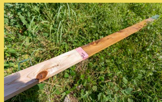
冬場の6ヶ月間太陽のもとで放置。写真右側半分が施工なし。左側半分がスマイルコーティング加工済み。放水後、水を吸った施工なし部分と、しっかりと撥水する加工部分が歴然と
